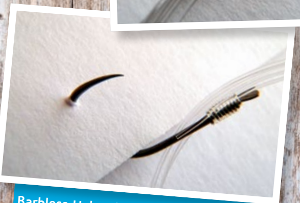
Barbless-Haken beim Papiertest: Der Haken dringt schnell ein, der Papierwulst ist klein.
