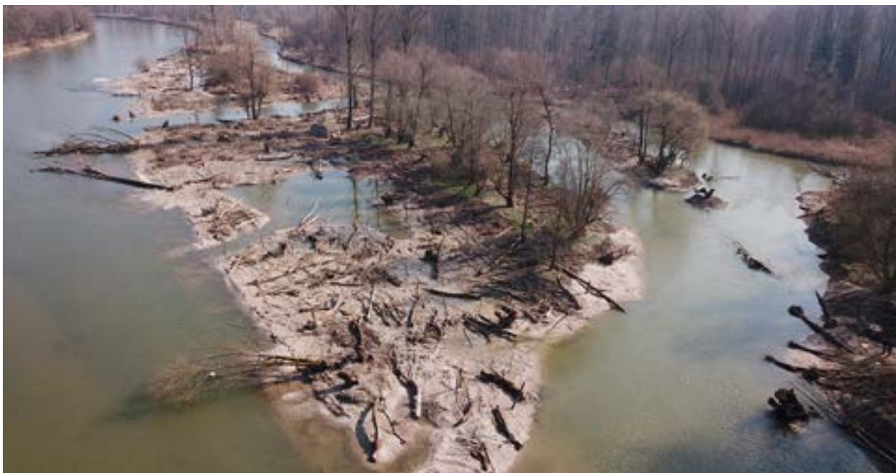
Rekultivierte „Untere Tradt“ der Isar bei Plattling mit Totholz, Kiesbänken, angebundenen Seitenarmen und Stillwasserzonen.
