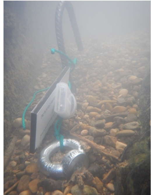
Abbildung 2 Datenlogger unter Wasser an einer in die Gewässersohle getriebenen Stahlstange befestigt
