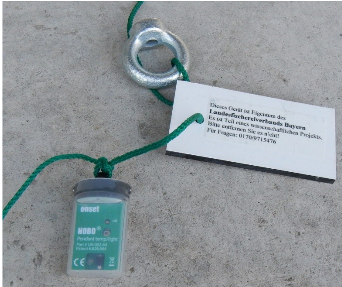
Abbildung 1 Hobo-Logger mit Schild und Ringmuttern zum Beschweren
