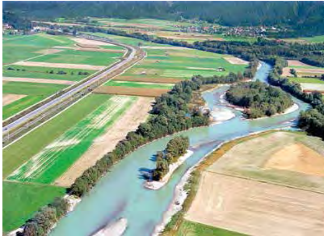
Diese ehemals monoton regulierte Strecke an der Drau hat sich nach Aufweitung und Herstellung eines Nebenarms dynamisch weiter entwickelt.
